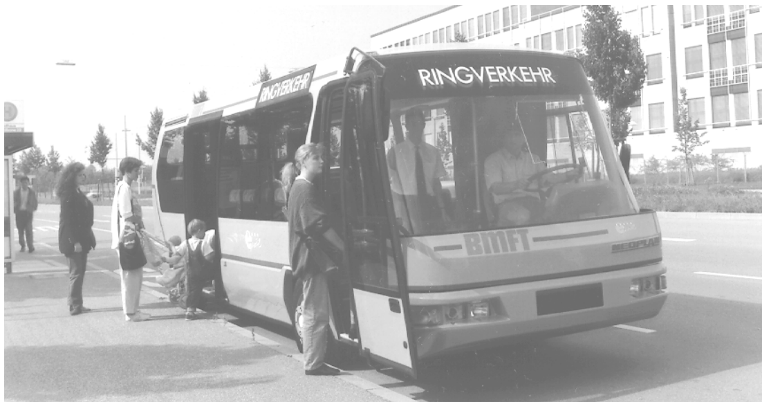
Bild 1: Einer von insgesamt 3 NEOPLAN N 8008 E Bussen mit ABB Hochenergiebatterien Na/S zum Einsatz auf der Insel Rügen
